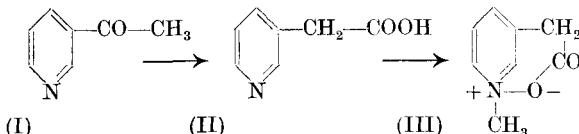
Äther-Gemisch in schönen Nadeln, die zunächst mit Alkohol kry-stallisieren, diesen beim Trocknen im Vakuum abgeben, aber noch 1 Mol Wasser enthalten und stark hygroskopisch sind. Die Substanz zersetzt sich langsam beim Schmelzen über 100° und schmilzt unter Zersetzung bei 130—132°. Das Betain liefert ein Chlorhydrat vom Smp. 167° (Zers.), das sehr hygroskopisch ist, und ein Pikrat vom Smp. 154—156°.
